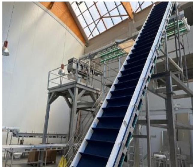
Cinta transportadora elevadora
