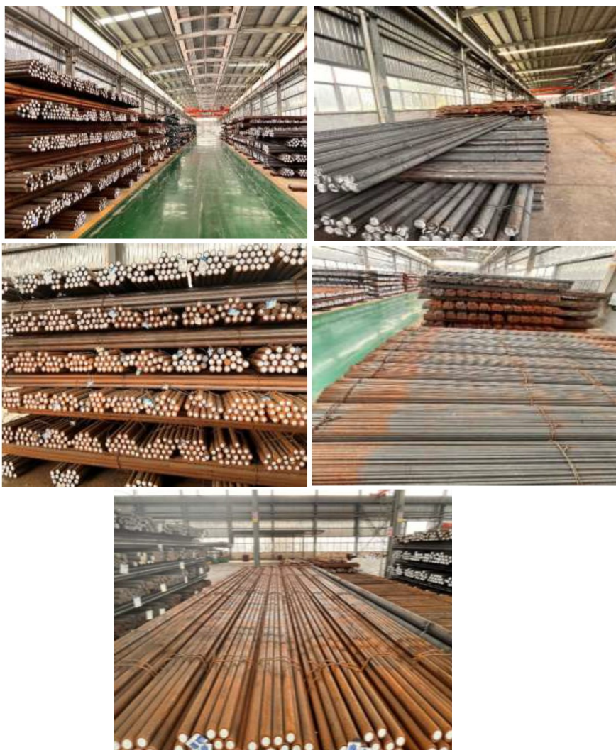
Mercancía: "BARRA DE ACERO ALEADO DE ALTO CARBONO" Presentación: LONGITUD: 6.00m±50mm, DIÁMETRO: 80mm Marca: NISCO Modelo: LT-B2 Fabricante: NANJING IRON&STEEL Co., Ltd.
